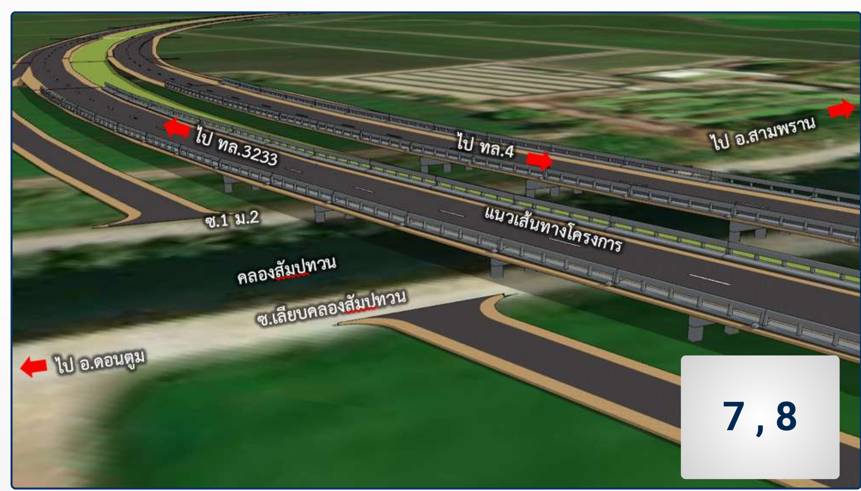
สะพานบกข้ามถนนท้องถื่น (ถนนเลียบคลองสัมปทวน)
